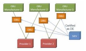
Figure 9. Suppliers and Providers of OBUs (SIEV-Sistema de Identificação Electrónica de Veículos, S.A, 2010)
