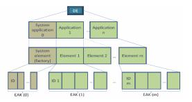
Figure 11. DE information structure (SIEV SIEV-Sistema de Identificação Electrónica de Veículos, S.A., 2010)
